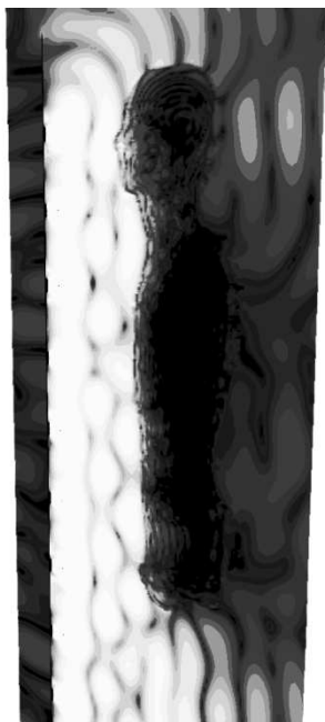
Slika 3: Realni del električnega polja znotraj človeka v bližini antene. Barvna skala je v logaritmskem merilu.
