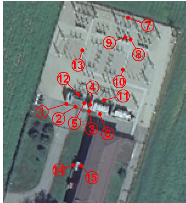
Slika 2: Merilna mesta v 110 kV, kjer so bile izmerjene najvišje vrednosti električne poljske jakosti.
