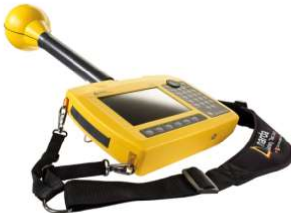
Slika 3: Instrument za merjenje elektromagnetnega sevanja, Narda SRM-3006 in primer izvajanja meritev EMS.
